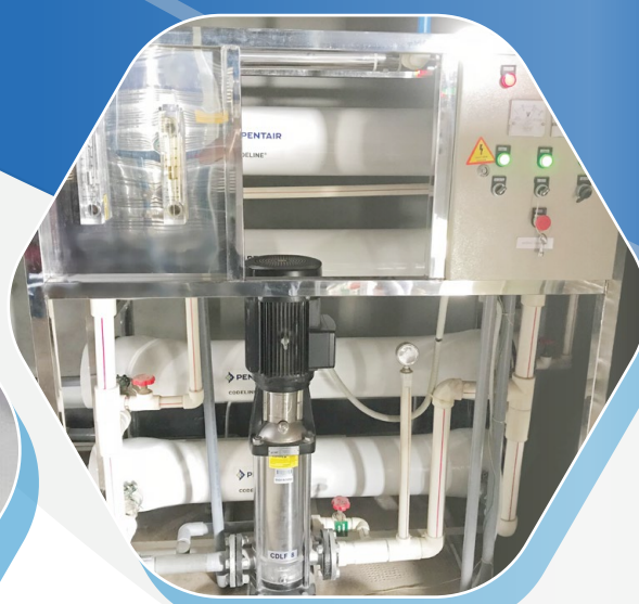
Hệ thống xử lý nước tinh khiết RO
